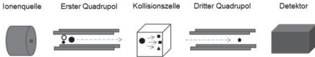
Abb. 5: Schematischer Aufbau eines Triple Quadrupol Massenspektrometers, entnommen aus (117).
