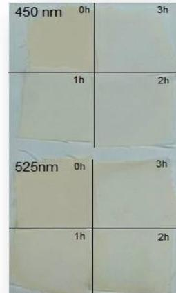
**Abbildung 188:** Variation der LED-Lampen und deren Auswirkung auf die Farbigkeit von  $\beta$ -Carotin (2), durchgeführt in Wasser, 100 % Intensität,  $d = 15$  cm,  $c = 10^{-7}$ M,  $T = 293$  K.
