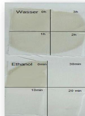
**Abbildung 191:** Variation der Reaktionsmedien und deren Auswirkung auf die Farbigkeit von Chlorophyll a (1a), durchgeführt in Wasser, blaue LED-Lampe (450 nm), 100 % Intensität,  $d = 15$  cm,  $c = 10^{-7}$ M,  $T = 293$  K.
