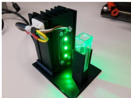
**Abbildung 62:** Versuchsaufbau zum Screening in einer Quarzküvette.
