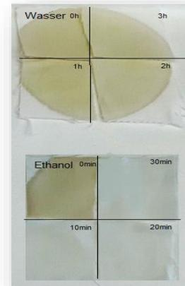
**Abbildung 190:** Variation der Reaktionsmedien und deren Auswirkung auf die Farbigkeit von Chlorophyll b (1b), durchgeführt in Wasser, blaue LED-Lampe (450 nm), 100 % Intensität,  $d = 15$  cm,  $c = 10^{-7}$ M,  $T = 293$  K.
