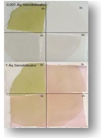
**Abbildung 194:** Variation der Äquivalente der Photosensibilisatoren und ihre Auswirkung auf den Abbau von Chlorophyll b (**1b**) sowie die Farbigkeit des Textils, durchgeführt in Wasser, blaue LED-Lampe (450 nm), 100 % Intensität,  $d = 15$  cm,  $T = 293$  K.
