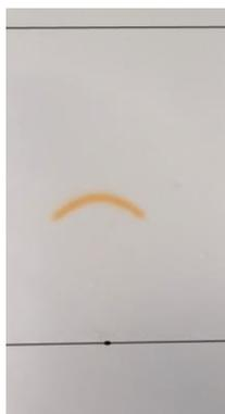
**Abbildung 55:** Dünnschichtchromatographie von Lycopin (**3**). Laufmittel: Petrolether/Dichlormethan, 9:1.
