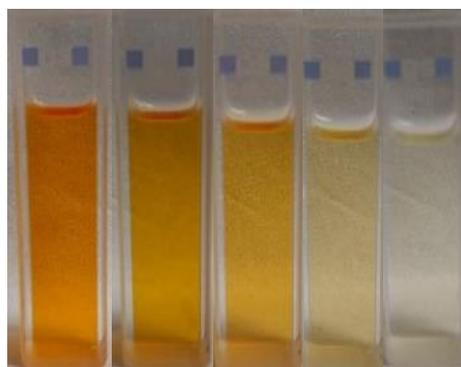
**Abbildung 94:** Abbau von Lycopin (**3**) durch Zugabe der Neutralrot Derivate **12a-f** als Photosensibilisator. Die Bestrahlung erfolgte in Chloroform durch eine blaue LED-Lampe (450 nm), 100 %,  $d = 1$  cm,  $c = 10^{-7}$  M.
