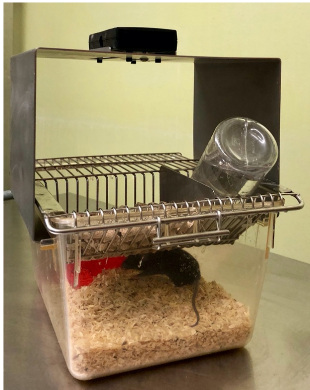
Abb. 4: Maus in Einzelhaltung. RH im Hintergrund erkennbar. Auf dem Käfig (standardisierter type 2 short cage ) befindet sich ein Aufsatz mit einem Infrarot-Detektor (Mouse-E-Motion, Hamburg, Germany) zur Registrierung und kontinuierlichen Aufzeichnung spontaner lokomotorischer Aktivität. Futter und Wasser ad libitum.
