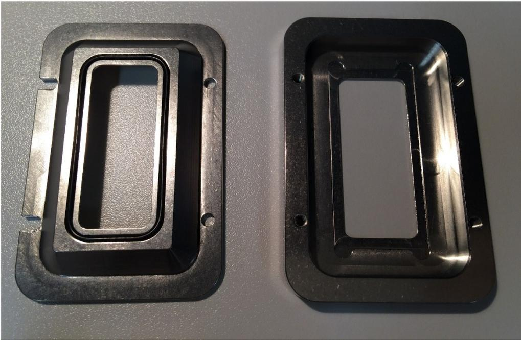
**Abb. 42** Metall-Messkammer im auseinander gebauten Zustand
