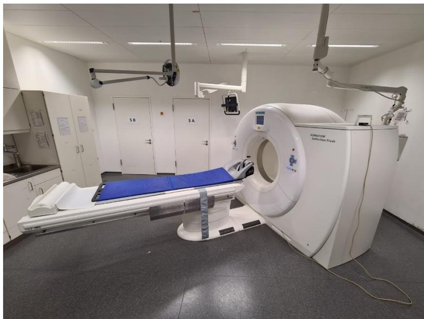
**Abbildung 3: ,Somatom Plus 4 Volume Zoom' Mehrzeilendetektor-CT (MDCT) der Firma Siemens, Gerätstandort: Uniklinikum Düsseldorf, Abteilung Radiologie. Die Aufnahme wurde genehmigt von Herrn Prof. Dr. Turowski. Die Aufnahme wurde von Frau Schadi Asadegan-Lemke ausgeführt.**
