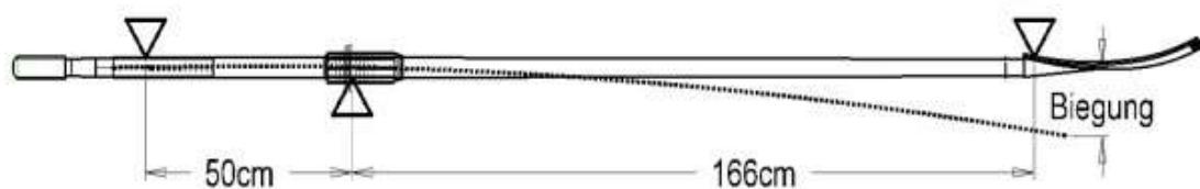
Abb. 7: Skizze eines Skulls mit Längenangaben in Zentimeter (cm)
