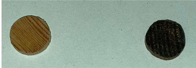
**Abbildung 36** Foto einer unbehandelten Holzscheibe (links) und eines MIL-100(Fe)@Kiefer-MA-Komposites (rechts).
