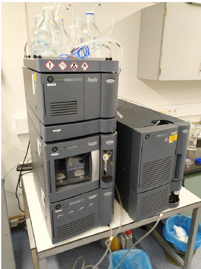
Abb. 17: Fotografie der verwendeten LC-MS/MS (Liquid Chromatography with Tandem Mass Spectrometry)-Anlage. Die Acquity UPLC® I-Class mit LG 500 nm Photodiodenarray-Detektor und Tripel-Quadrupol- (TQD-) MS (Waters, Eschborn) wurde durch das Institut für Rechtsmedizin des Universitätsklinikums Düsseldorf zur Verfügung gestellt.
