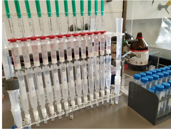
Abb. 14: Darstellung der Festphasenextraktion zur Aufreinigung von 6-Keto-Prostaglandin F_{1\alpha} (6-Keto-PGF _{1\alpha} ). Die Trennsäulen wurden in einer selbst angefertigten Apparatur eingespannt. Mithilfe spezieller Spritzenadapter (rot) konnte durch Druckausübung durch die Spritze eine nahezu konstante Fließgeschwindigkeit erreicht werden.
