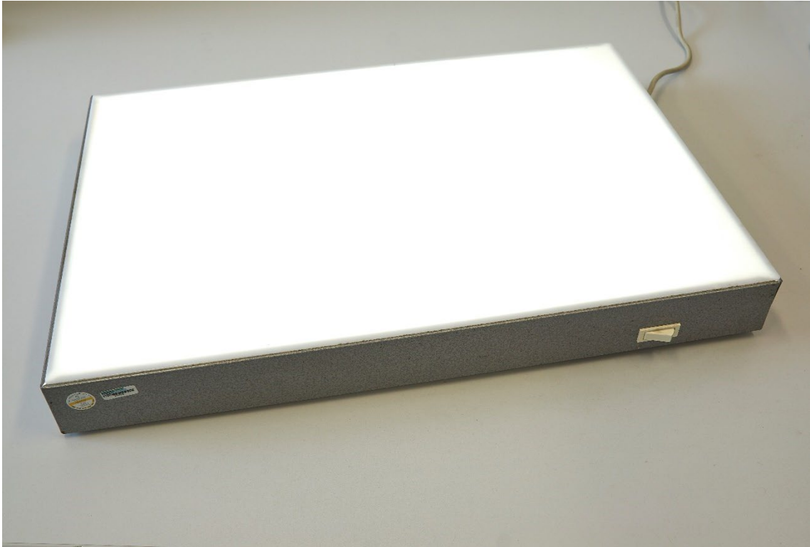
Abb. 6: Konventioneller Leuchtkasten mit eingeschalteter Beleuchtung
