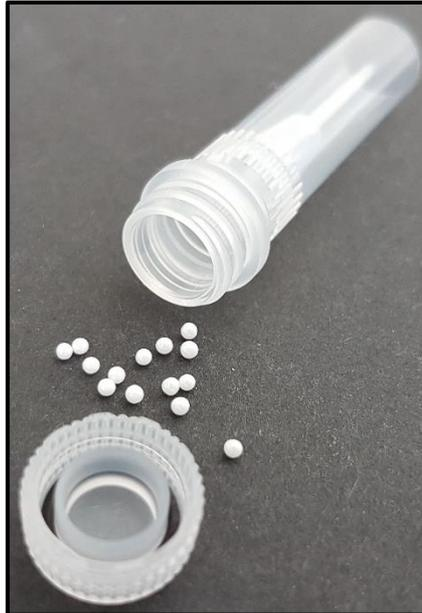
**Abb. 1:** Verwendete Keramikugeln
