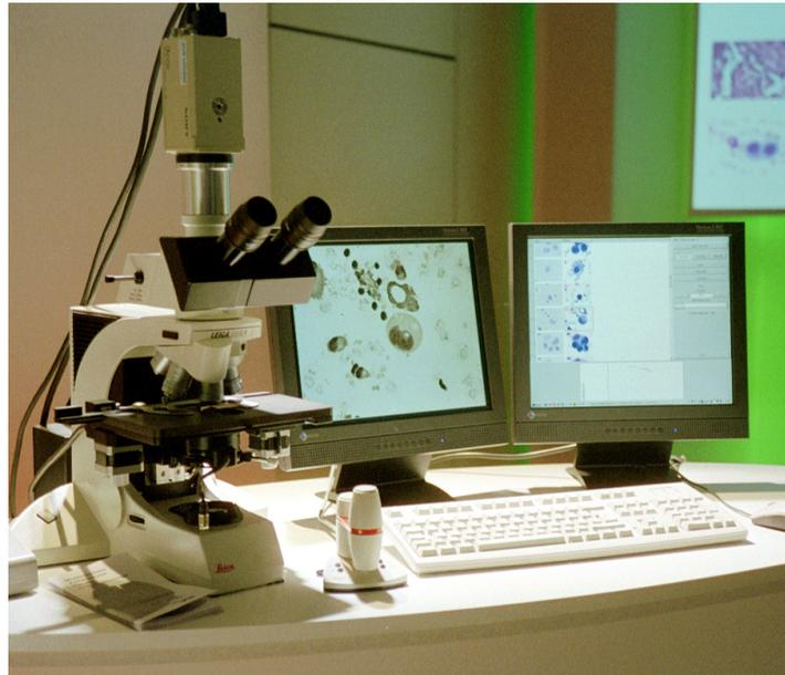
**Abb. 2.1:** Ansicht des Labormusters mit Mikroskop, CCD-Kamera und Computer
