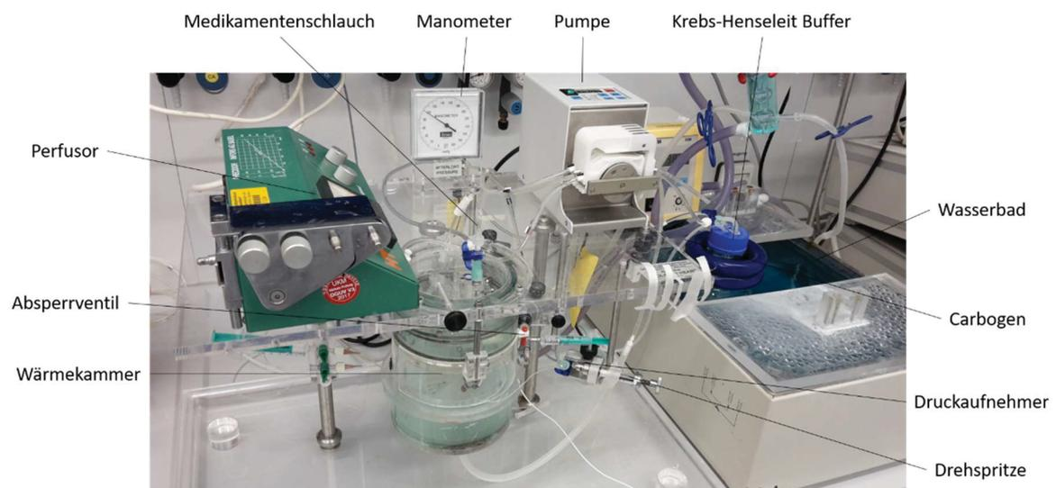
**Abb. 2: Versuchsaufbau des Langendorff-Perfusors im kardiologischen Labor der Heinrich-Heine-Universität.** Die einzelnen Bestandteile der Langendorff-Apparatur (Hugo Sachs Elektronik, March) werden im Text näher erläutert.
