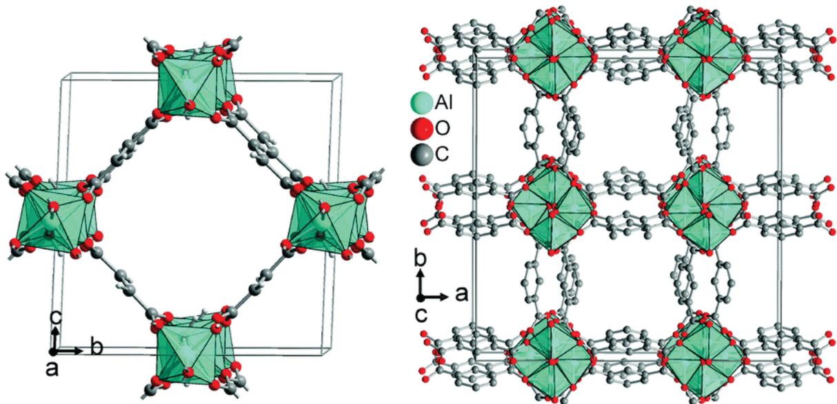
Abbildung 1: Struktur von Aluminiumfumarat auf der linken Seite und CAU-10H auf der rechten Seite, welches in der Struktur MIL-160 entspricht. Die Aluminiumatome sind polyhedral dargestellt. Entnommen aus Referenz 48 mit Genehmigung der Royal Society of Chemistry.
