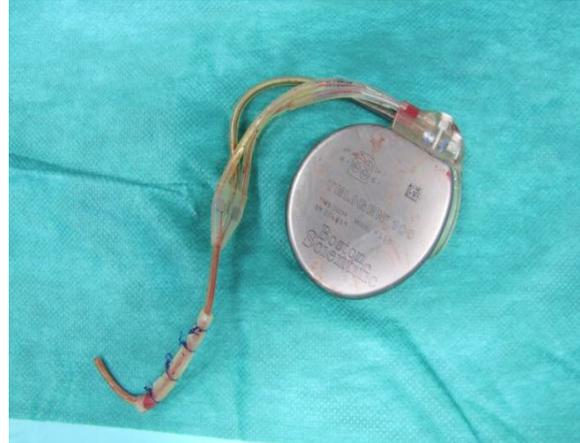
**Abb. 8: Reparatur des Verbindungselements der Defi-, Pace- und Sense-Konnektoren einer ICD-Sonde**
