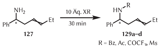
Schema 78: Derivatisierung des Homoallylamins 127 mit verschiedenen Säurechloriden oder -anhydriden. a Reaktionsbedingungen: 0.20 mmol 127 und 10 Äq. Derivatisierungsreagenz für 30 min geschüttelt und mit n Heptan extrahiert.
