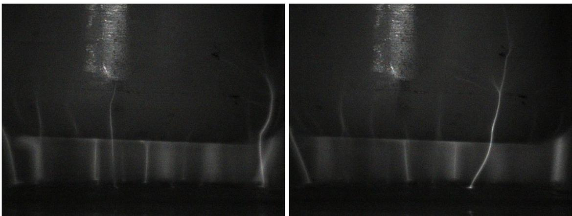
Abbildung 2: Nahaufnahme mit einer Hochgeschwindigkeitskamera von DBD-Entladungen über humaner Dermis. Es zeigen sich elektrische Entladungen in Form von Filamenten. (Bilder mit freundlicher Genehmigung der Ruhr-Universität Bochum)
