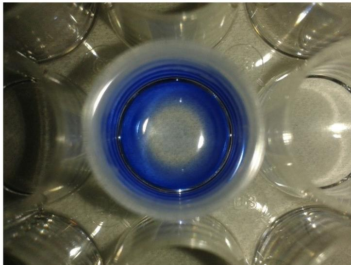
Abbildung 8: Well-Platte mit eingefärbtem PBS. Mittig zeigt sich nach Plasmabehandlung ein trockener Bereich.
