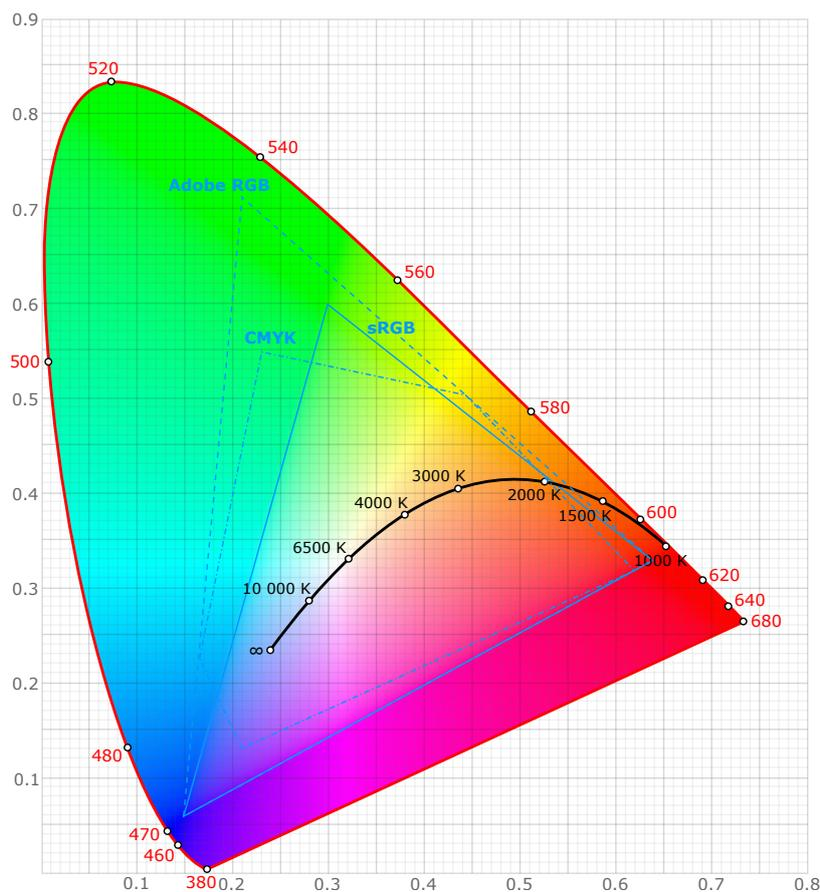
Abbildung 1.2: CIE-Normfarbraum mit gekennzeichnete Spektralfarblinie (rot, Werte in nm) und drei häufig genutzten Farbräumen (blau). Die *black body curve* (schwarz) ist mit einigen ausgewählten Temperaturen ebenfalls eingezeichnet.
