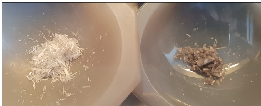
Abbildung 3-1: Darstellung der bei Umsetzung von \text{SnCl}_2 und \text{GaCl}_3 in Chlorbenzol erhaltenen Kristalle von [\text{SnCl}][\text{GaCl}_4] ( 2 , links, farblos) und \text{Sn}[\text{GaCl}_4]_2 ( 3 , rechts, grau). Die Unterschiede der Kristallgröße, -form und -farbe sind in dieser Darstellung deutlich zu erkennen.
