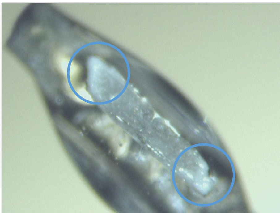
Abbildung 3-3: Darstellung oberflächlicher Zersetzungserscheinungen am Beispiel von kristallinem Material der Verbindung 10 . An den Enden der dünntafeligen Nadel (blaue Markierungen) ist mikrokristallines Material zu erkennen.
