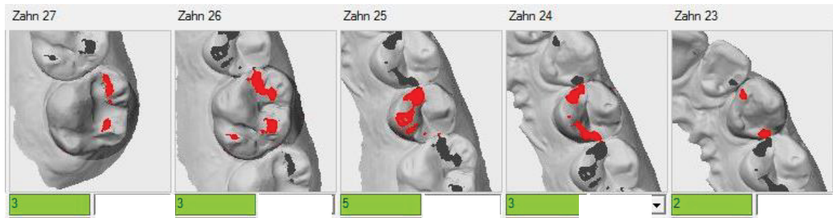
Abbildung 30: Darstellung der ermittelten Kontaktanzahl am Scandatensatz des Intraoralscans pro Zahn im GEDAS System.
