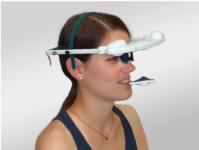
Abbildung 18: Optic Jaw Motion Analyser mit Oberkieferkopfbogen und Unterkiefer Sensor.
