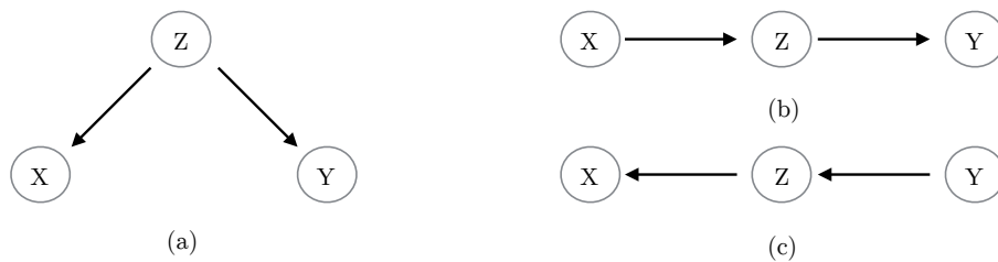
Abb. 3.2: Z als gemeinsame Ursache von X und Y (a), als direkte Ursache von Y (b) und als direkte Ursache von X (c)
