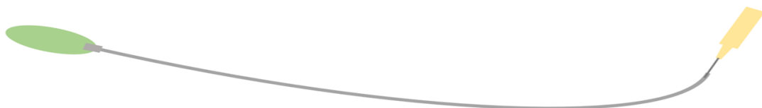
Abb. 7: Schematische Darstellung des angefertigten Katheters. Der Katheter setzt sich zusammen aus einem angepassten Ballon, welcher über einen Tubus mit einer abgestumpften 26G Kanüle verbunden ist.
