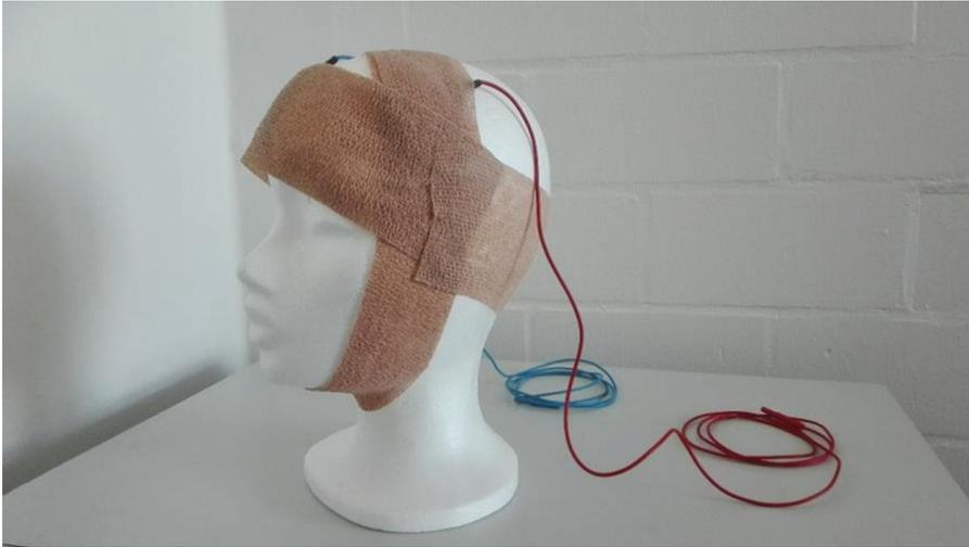
**Abb. 3 Befestigung der Elektroden** Exemplarische Darstellung der Befestigung und Lokalisation der Stimulations- und Referenzelektrode. Das rote Kabel führt zur Stimulationselektrode, das blaue zur Referenzelektrode.
