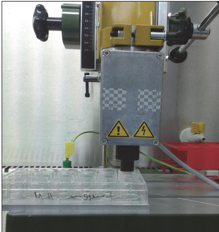
**Abb. 7: DBD-Plasmastick, fixiert in einer linear verstellbaren Aufhängung über einer Wellplatte in der Sterilwerkbank mit Erdung (Gelb-Grüne Elektrode im Hintergrund).** Typischer Versuchsaufbau zur Behandlung von Zellkulturen. Fotografiert während der Forschungen für diese Arbeit im LifeScienceCenter,, Merowingerstr. 1a Düsseldorf.
