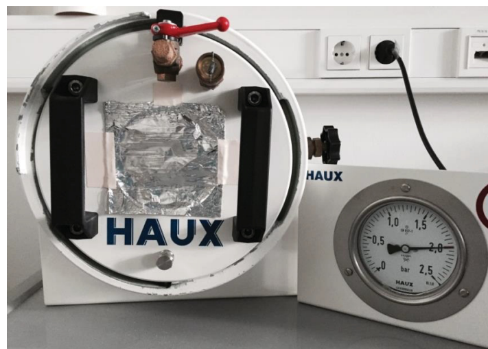
Abb. 2 HAUX-TESTKOM 200/2 HBO-Kammer. Die Zellen wurden für 2 h einer Sauerstoffüberdruckbehandlung mit 2 bar in der HBO-Kammer ausgesetzt, eine parallel neben der Kammer aufbewahrte Platte diente als Raumluftkontrolle. HBO = hyperbarer Sauerstoff
