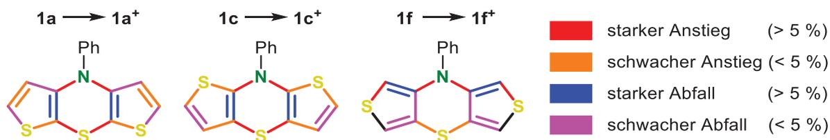
**Abbildung 25.** Relative Änderung der Wiberg-Bindungsordnungen bei der Oxidation von **1a**, **1c** und **1f** zu den Radikalkationen **1a<sup>+</sup>**, **1c<sup>+</sup>** und **1f<sup>+</sup>** im Dithieno[1,4]thiazin-Grundgerüst (uB3LYP/6-311G\*).
