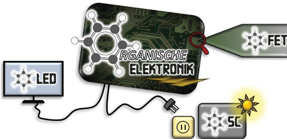
**Abbildung 5.** Die Hauptzweige der Organischen Elektronik – Organische Feldeffekttransistoren (OFET), Organische Solarzellen (OSC) und Organische Leuchtdioden (OLED).
