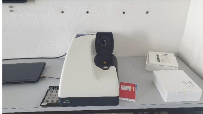
**Abbildung 37** Fotografie des verwendeten *Malvern Zetasizer Nano-S* mit welchem Messungen der dynamischen Lichtstreuung durchgeführt wurden.
