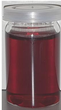
**Abbildung 21** Citrat-stabilisierte Gold-Nanopartikel, welche die typische rote Färbung von Au-NP aufweisen.
