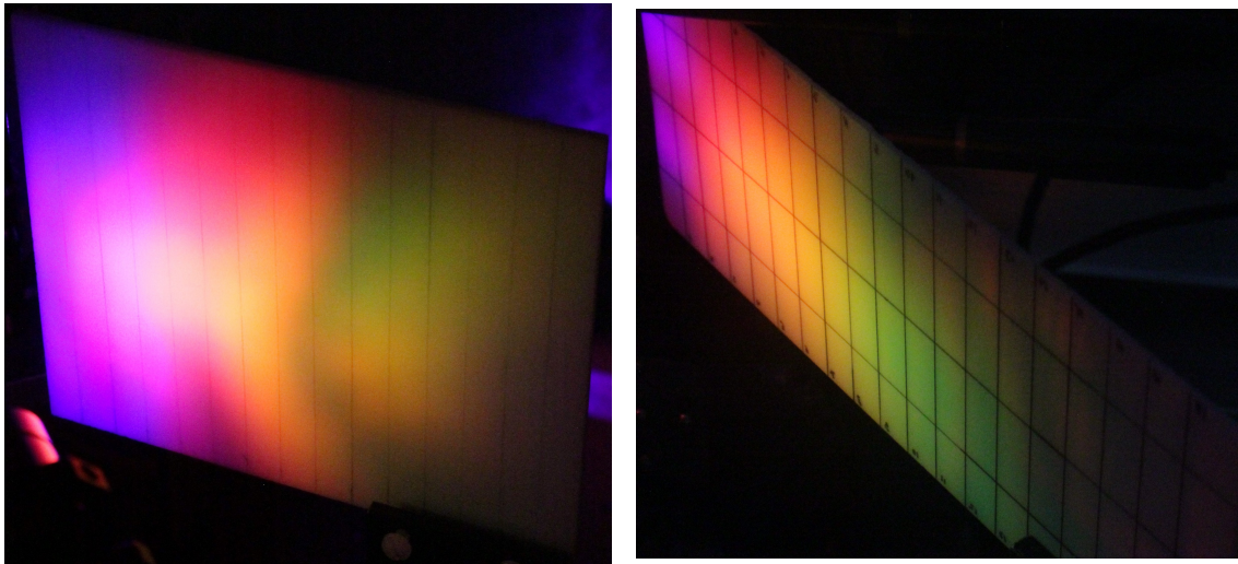
Abbildung 6.12: Zwei Aufnahmen des reflektierten Laserlichts eines 7 fs Laserpulses, der mittels einer 3 Zoll Parabel auf ein Glaskohlenstoff-Target fokussiert wurde. Die beiden Aufnahmen sind in unterschiedlichen Experimentierkammern entstanden und der Blickwinkel auf den Schirm ist unterschiedlich. Die Schirme sind parallel zum Target ausgerichtet, die linke Kante weicht in etwa 3^\circ von der Targetnormalen ab und das grüne Licht propagiert in etwa in Reflexionsrichtung. Die Schirme stehen etwa 12,7 cm von dem Target entfernt und die vertikalen Teilstriche haben einen Abstand von einem Zentimeter zueinander. Typische Fluktuationen sind in Abbildung B.3 dargestellt.
