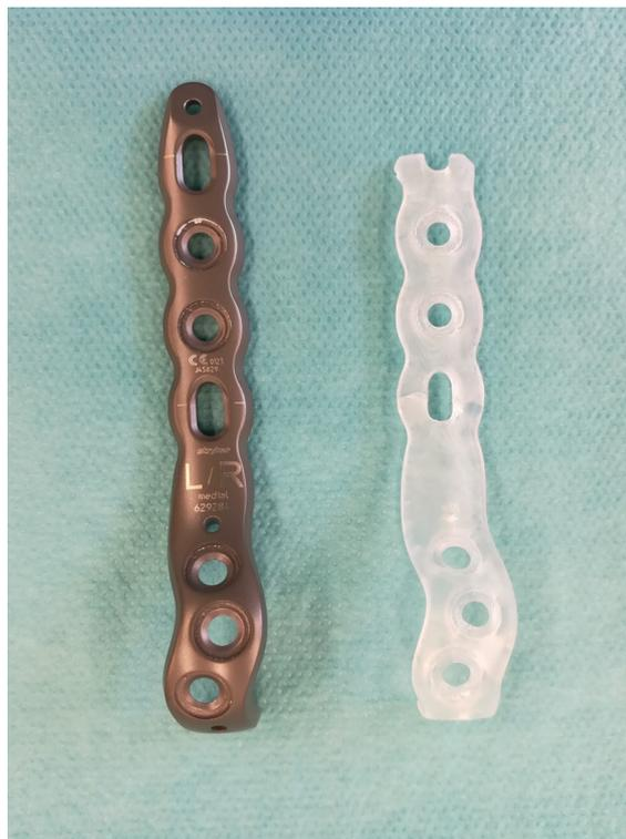
**Abb. 2.12: Plattennachbildung.** Abbildung der originalen Osteosyntheseplatte der Firma Stryker aus Titan (links im Bild) und des im 3D-Drucker erstellten Replikats (rechts im Bild). Das Replikat ist aus produktionstechnischen Gründen am proximalen - und damit vom Untersuchungsbereich entfernten - Ende leichtgradig gekürzt.
