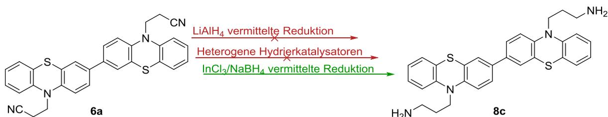
**Schema 73:** Übersicht über die untersuchten Reduktionsmethoden zur Einführung der primären Aminfunktionalitäten an die Diade **6a**.
