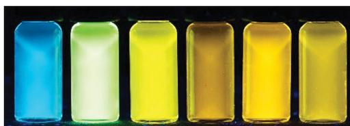
**Abbildung 3.33:** Fluoreszenz der Verbindung **23h** in Lösungsmitteln unterschiedlicher Polarität (von links nach rechts: Cyclohexan, Toluol, Chloroform, Ethylacetat, Tetrahydrofuran, Dichlormethan;  $\lambda_{exc} = 365 \text{ nm}$ ).
