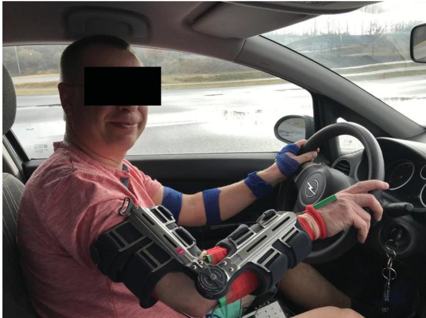
**Abbildung 2** Studienteilnehmer mit angelegten Elektrogoniometern am rechten und linken Handgelenk und Ellenbogen während des Führens eines Kraftfahrzeugs auf dem Testgelände des ADAC. Um eine Bewegungseinschränkung zu simulieren wurde in diesem Versuchsaufbau zusätzlich eine Hartrahmenorthese am rechten Ellenbogen angelegt. Mit freundlicher Genehmigung des Probanden (Eigene Darstellung).
