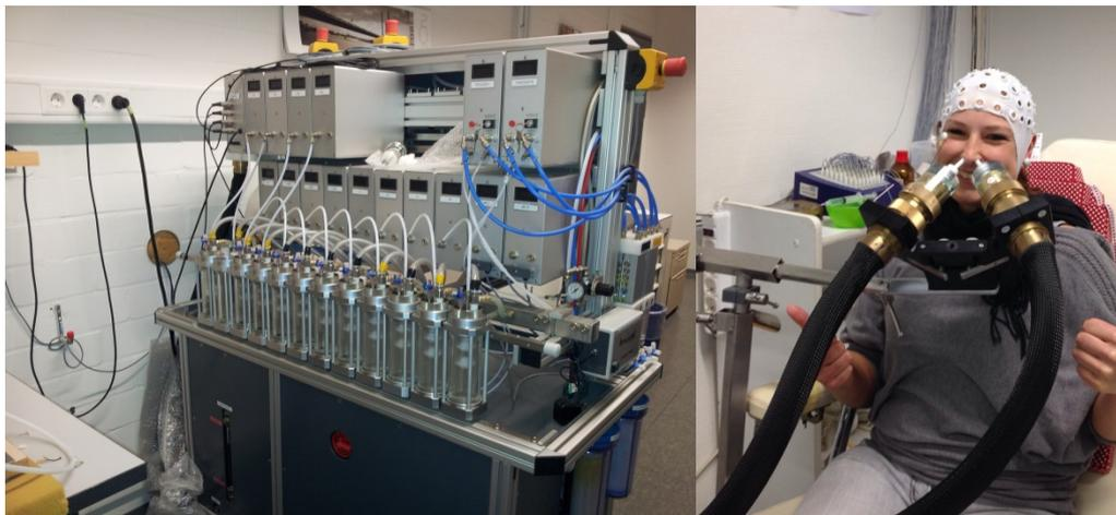
Abbildung 8. links: 8-Kanal-Olfaktometer OL023, rechts: Positionierung des Probanden. Die beiden Nasenstücke des Olfaktometers führen den Luftstrom in die beiden Nasenvorhöfe des Probanden.
