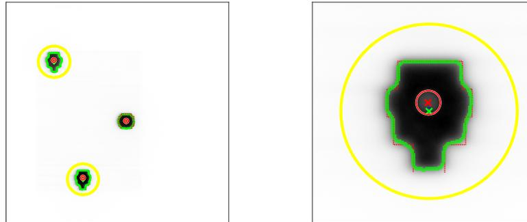
**Abbildung 4.8:** Ergebnis eines WL-Tests mit mehreren nicht isozentrisch positionierten Zielvolumen. Links: Ein ausgewertetes Bild. In grün sind die Feldkanten der Bestrahlungsfelder und deren Mittelpunkte dargestellt. In rot sind die Kugelränder und deren Zentren gezeichnet. Die gelbe Markierung um zwei der Feldöffnungen soll eine Abweichung der jeweiligen FM und KM signalisieren, die größer ist als 1 mm ist. Rechts: Nahaufnahme eines markierten Feldes.
