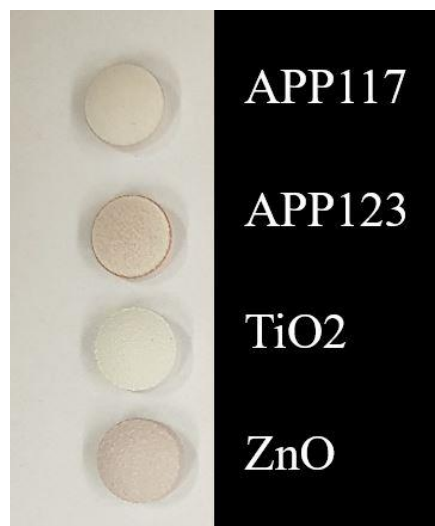
Abbildung 35: Rote Tabletten, beschichtet mit vier verschiedenen weißen Überzügen bei einem Massenauftrag von 7\% .
