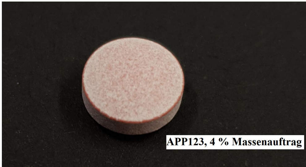
Abbildung 36: Rote Tablette mit einem Massenauftrag von 4 % APP123.
