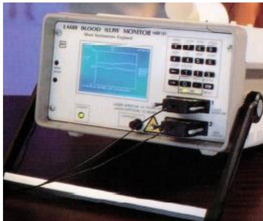
**Abbildung 4: MBF3D, Moor Instruments, 2-Kanal-Laser-Doppler-Flussmessgerät (Quelle: Moor Instruments)**
