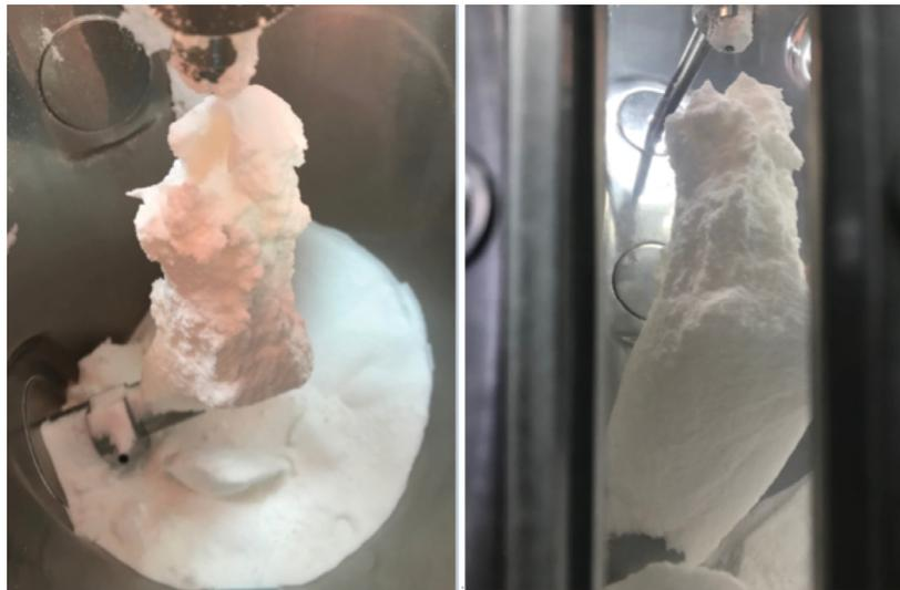
Abbildung 3.16: Produktablagerung auf der Sonde bei hohem Sprühdruk
