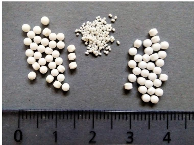
Abbildung 34. Überzogene Diclofenac-Pellets (Mitte), sowie Tabletten mit überzogenen Diclofenac-Pellets mit dem Füllmittel Prosolv® ODT (links) oder Pearlito® Flash (rechts), Herstellung unter Verwendung eines Pressdrucks von 128 MPa
