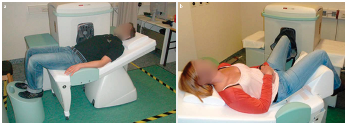
► Abb. 1 Niederfeld-MRT 0.2 Tesla Extremität Unit (Esoate, C-Scan, Esaote Biomedica Deutschland GmbH). a Lagerung eines Patienten für eine MRT-Untersuchung der Hand; b Lagerung einer Patientin für die MRT-Untersuchung des Fußes.
