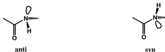
Abb. 2.10.: Alternative Konfigurationen des Übergangszustands bei der Rotation der Amidbindung
