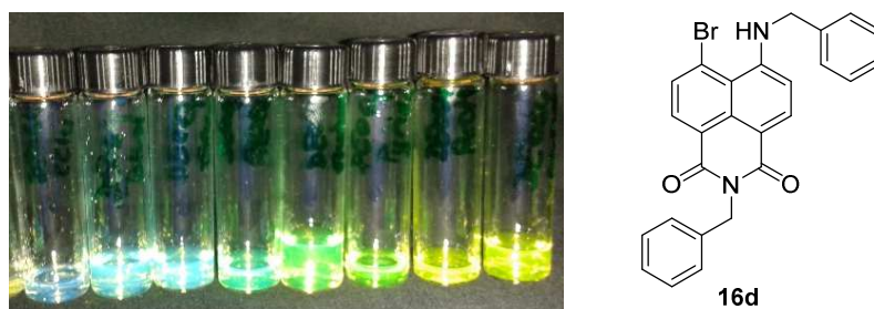
Abbildung 5.38: Fluoreszenz von 2-Benzyl-6-(benzylamino)-7-brom-1H-benzo[de]isochinolin-1,3(2H)-dion ( 16d ) mit zunehmender Lösungsmittelpolarität (von links nach rechts: CCl 4 , Toluol, EtOAc, Aceton, Pyridin, AcOH, EtOH; \lambda_{\text{exc}} = 365 \text{ nm} ).
