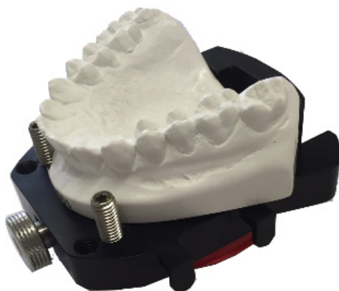
Abb. 11: Oberkiefermodell im Objekthalter. Die Halteschrauben liegen anterior, der Objekthalter ist basal
