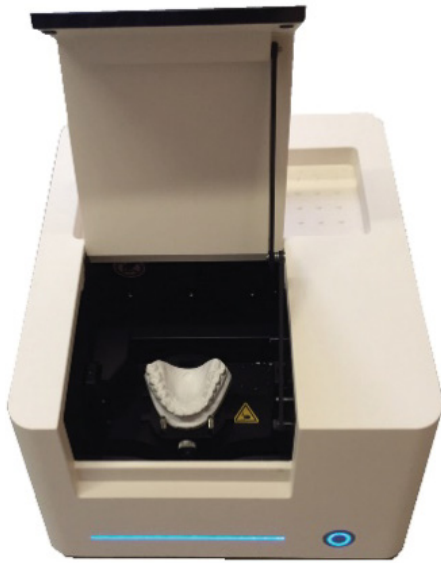
Abb. 5: Optischer Scanner mit im Objekthalter eingespanntem Gipsmodell
