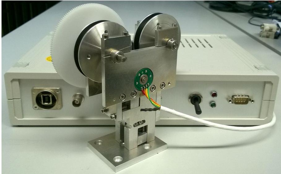
**Abb. 3.6:** Fotografie des Bandlaufwerks vor dem eigenständig assemblierten Steuergerät. Änderungen zu Konstruktionszeichnungen werden im Text diskutiert.
