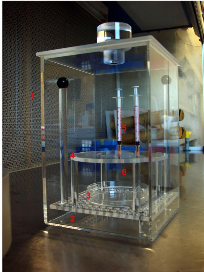
Abb.4: Vorrichtung zur Isolierung muriner Aortenendothelzellen gebaut in der Feinmechanischen Werkstatt der Physiologie der HHU-Düsseldorf.
