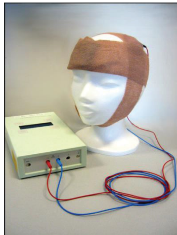
Abbildung 3: Fixierung der Stimulationselektroden. Die Elektroden sind mit dem Gleichstromstimulator verbunden.
