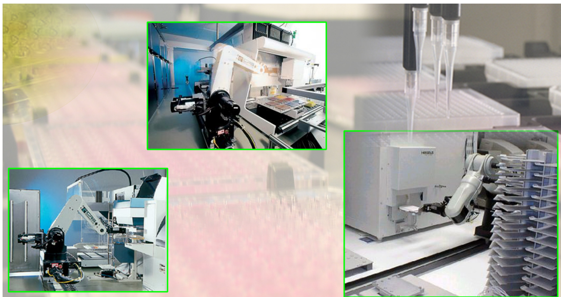
Abbildung 1.1. Beim experimentellen High-Throughput Screening werden hochautomatisierte Robotersysteme eingesetzt.
