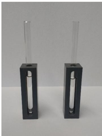
**Abb. 21:** Aufbau zur Absorbanzmessung im NMR-Röhrchen
