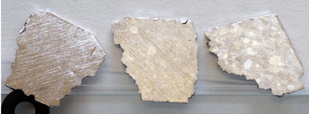
*Abbildung 97: drei grobkristalline Ta-Proben; von links nach rechts- lange elektropoliert (10 s), kurz elektropoliert (2 s bei ca.  $0,8 \text{ A}\cdot\text{cm}^{-2}$ ) sowie nur mit Isopropanol und Ethanol gereinigt.*
