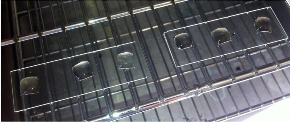
*Abbildung 157: Quadratische Proben mit aufgetropften 0,25 ml Versuchslösungen, gehalten durch die Oberflächenspannung vor dem Trocknen im Trockenschrank.*
