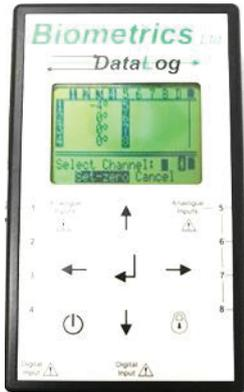
**Abb. 9** : DataLog-Box – Eingang der Elektrogoniometer und Datenverarbeitung.
