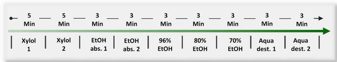
**Abbildung 18: Schematischer Ablauf der Entparaffinierung als Vorbereitung der immunhistologischen Färbung**
