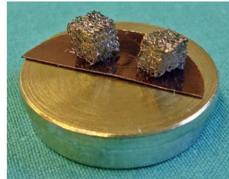
Abb. 6: Gold-beschichtete ICBM auf Träger für die REM
