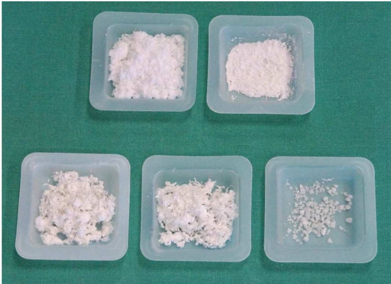
Abb. 5: Polymerpulver: RESOMER R 203 H, RESOMER RG503 H, RESOMER RG504 H, RESOMER RG505, RESOMER L 206 S (je 200µg, v.l.n.r und v.o.n.u.):
